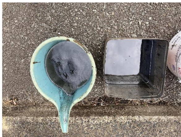
No. 3 水中ポンプのオイル状況(黒濁)
